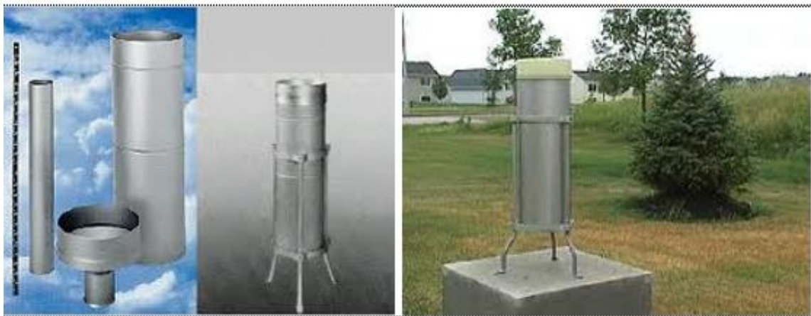
ຮູບທີ 1 ສະແດງເຄື່ອງວັດແທກນ້ຳຝົນແບບ standard 8 inch rain gage
