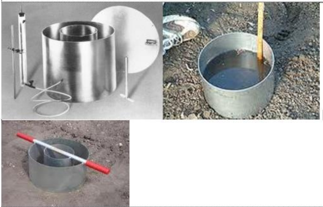
ຮູບທີ 3 ສະແດງ ກະບອກວັດແທກການຊຶມ Ring Infiltrometer
